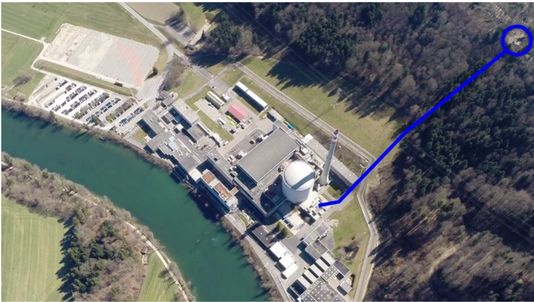
Abbildung 1 KKM mit Hochreservoir und ungefährem Verlauf Zuleitung
