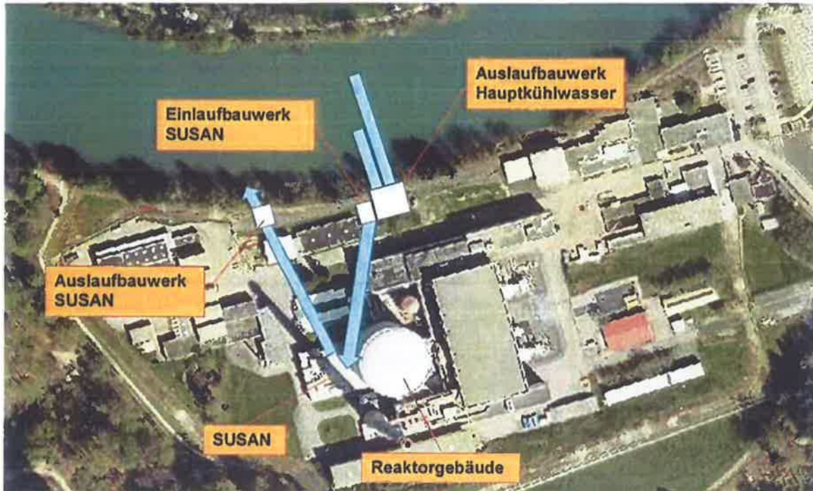
Anlagenübersicht mit Wasserfluss im SUSAN-Notstandsbetrieb
