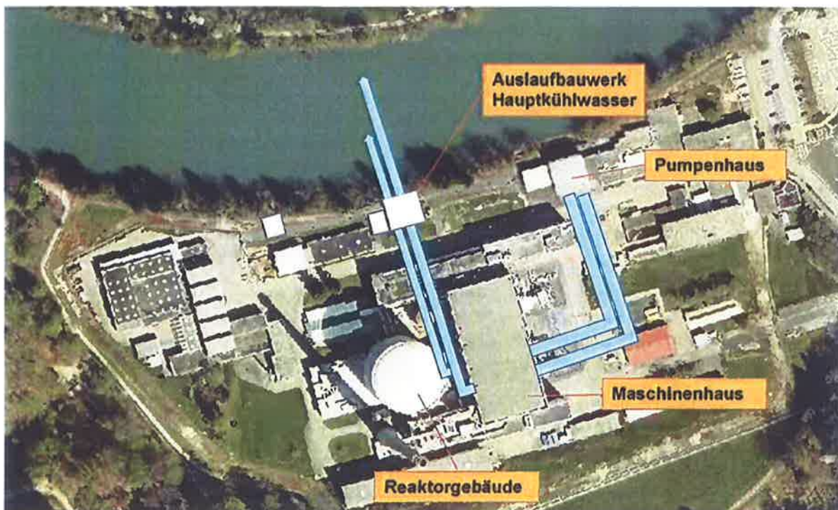
Anlagenübersicht mit Wasserfluss im Normalbetrieb
